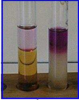
الوثيقة-9- بعد تحريك الخليطين، انتزع السيكلوهكسان معظم ثنائي اليود المذاب في الماء.
